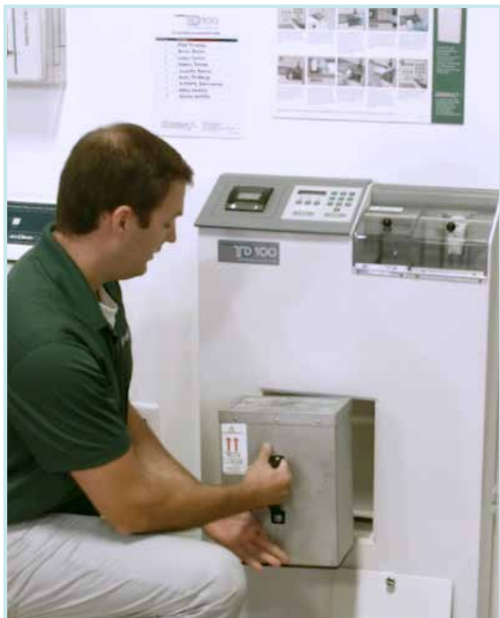
Ingeniero de servicio médico de CS completando el proceso de mantenimiento del filtro de vapor.
