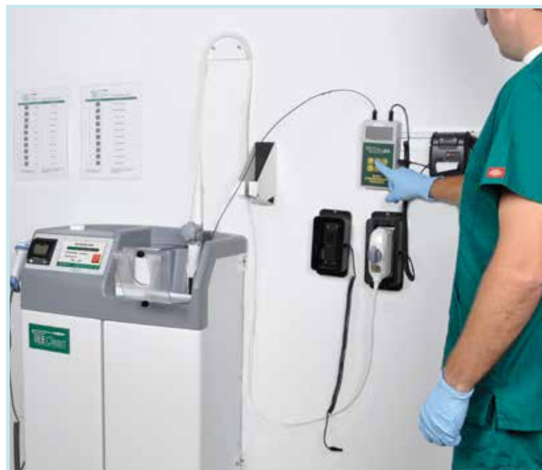
Las pruebas de fugas eléctricas se pueden realizar mientras se está dentro de TEEClean
